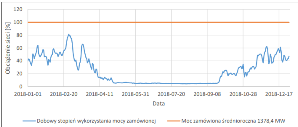
Rysunek 41 Roczny profil obciążenia sieci ciepłowniczej w odniesieniu do średniorocznej wartości mocy zamówionej w źródłach ciepła w 2018 roku.
