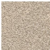
POZOSTAŁE CIĄGI KOMUNIKACYJNE NAWIERZCHNIA WYLEWANA Z KRUSZYWEM EKSPONOWANYM (JASNOBEŻOWA)
