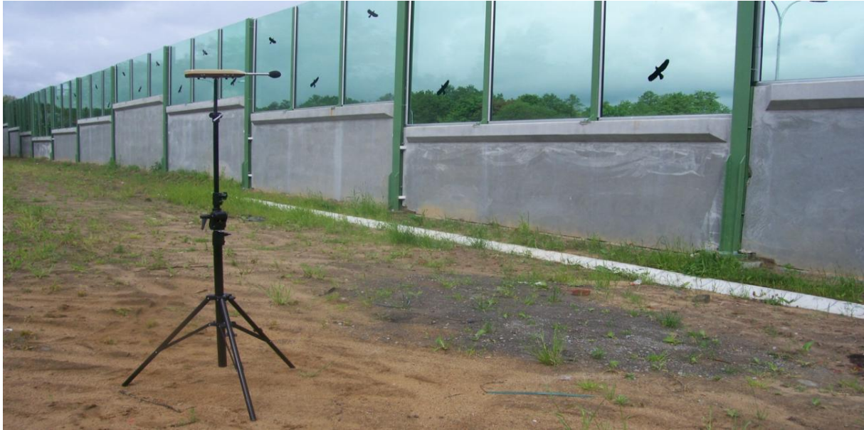
Rysunek 12. Widok punktu pomiarowego P0 położonego 5m za ekranem przy ulicy Św. Pio
