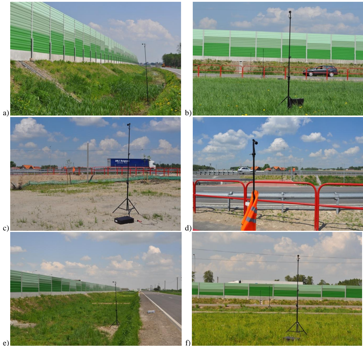
Rysunek 9. Przekroje pomiarowe w otoczeniu DK 8: a), b) przekrój E-1 (ekran 4,7m); c), d) przekrój E-3 (bez ekranu); e), f) przekrój E-2 (ekran 2,7m) – mikrofony na wysokości 1,2m nad nawierzchnią drogi Źródło: Opracowanie własne.
